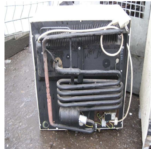
Ammoniás hűtőgépek (NH 3 )
