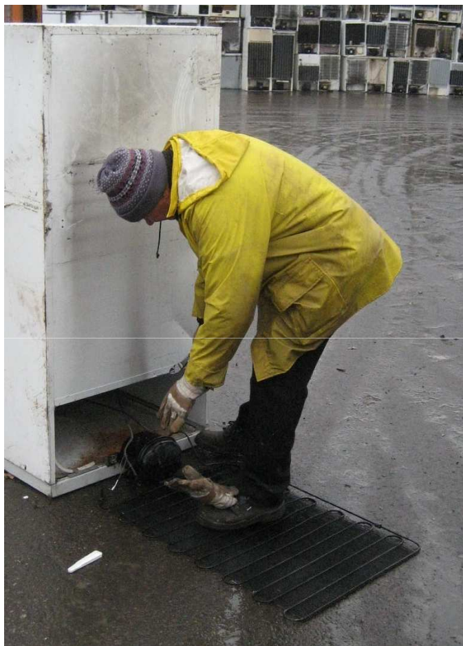
A munkatárs eltávolítja az FCKW-kompresszort rögtön a lerakodás után
